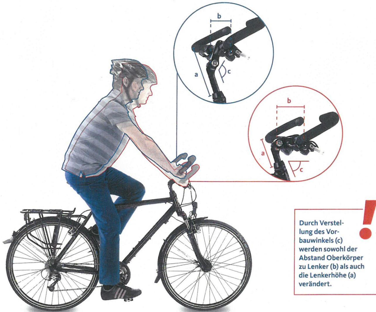
**Durch Verstellung des Vorbauwinkels (c) werden sowohl der Abstand Oberkörper zu Lenker (b) als auch die Lenkerhöhe (a) verändert.**
