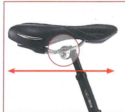
Der Sattel lässt sich auf dem Sattelgestell verschieben. Die richtige horizontale Position sorgt für eine optimale Hebelstellung der Beine. Das verhindert Knieschmerzen und schmerzhafte Beckenfehlstellungen.
