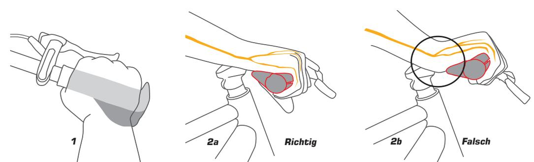
*Abb. 1:* Ergonomischer Griff: Die Innenhand liegt auf dem anatomisch geformten Griff. Mehr Kontaktfläche bedeutet: Der Druck wird besser verteilt. Nerven und Gefäße werden im innenseitig verlaufenden Karpaltunnel nicht mehr gequetscht.
