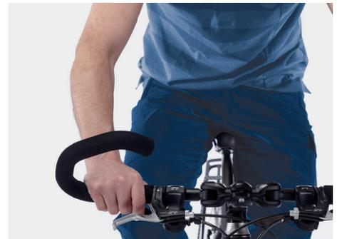
Ideal für „dynamisches Fahren“ sind **Multipositionslenker**. Die geschwungenen Lenkerenden der sogenannten Hornlenker bieten den Händen ganz verschiedene Griffoptionen. Die aktive Abwechslung mit unterschiedlicher Anspannung ist für die Hände, die Arme und den Rücken auf einer längeren Fahrt pure Erholung.
