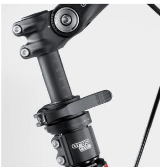
**Links:** Fahrrad mit „Ahead“-Vorbau: Der Adapter Up&Down von ergotec ist auf der Gabel montiert, oben sitzt wie üblich der Ahead-Vorbau.
