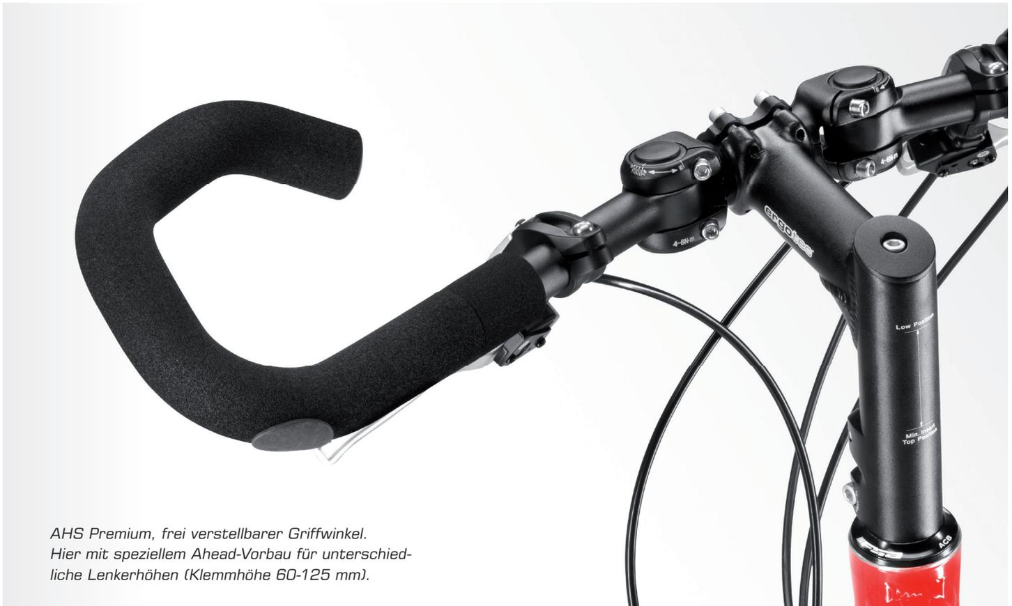
AHS Premium, frei verstellbarer Griffwinkel. Hier mit speziellem Ahead-Vorbau für unterschiedliche Lenkerhöhen (Klemmhöhe 60-125 mm).
